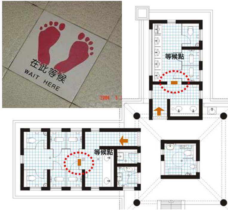
圖 2-3 標示等候線地磚之案例(二二八公園公廁)
