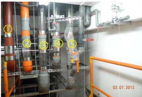
圖 15 排水立管底部正壓現象測試
