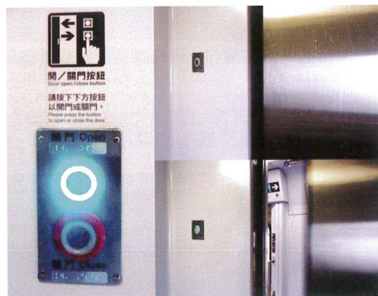
電聯車：以燈號顯示有無通電，防止停電意外
