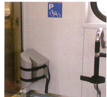
電聯車：可將自行車繫於車門旁的凹槽加以固定
