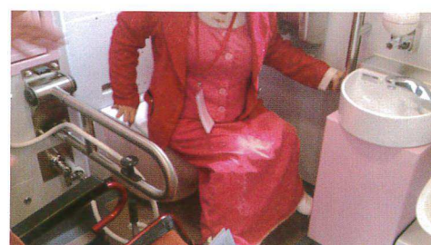
普悠瑪號：洗手台下方未預留空間， 造成輪椅通行的阻礙，這就是過度設計
