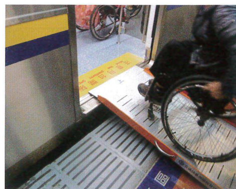
電聯車：金屬製斜坡板
