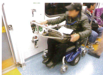
電聯車：車門旁之輪椅席，可直接固定輪椅
