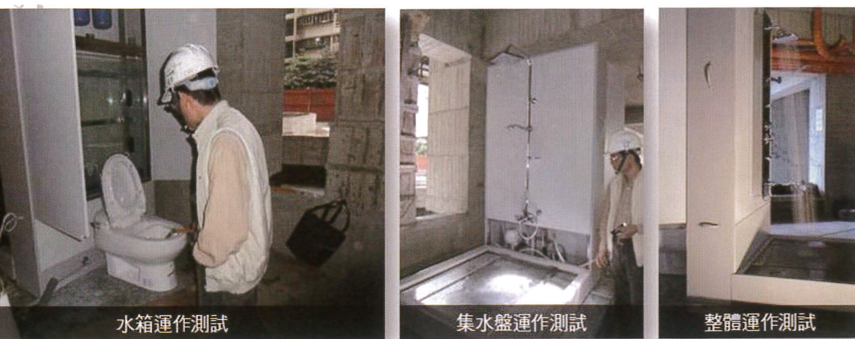
圖 14. 綠色水系統實體模型整體運轉測試
