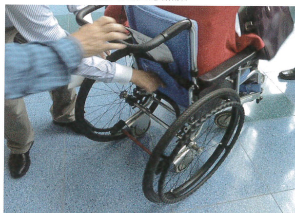
輪椅拆卸大輪方法很簡單，只要坐輪椅下方倒 U 型把手往上提即可，相當理想。
