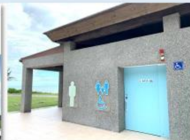
行碼視覺意識設計，明確導引使用動線，梁下留設開口，改善通風及採光。
