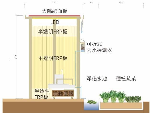
圖 5 雨水回收設備與種植蔬菜系統
