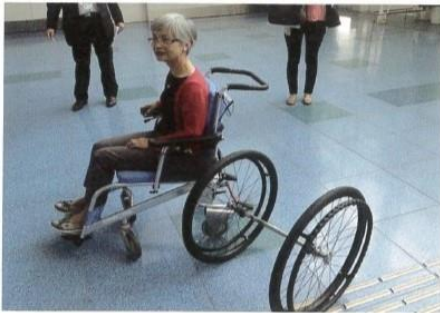
羽田機場 UD 設計，輪椅可拆卸變成寬度小於 70CM，可直接駛進機內通道，而上機過橋亦無段差。
