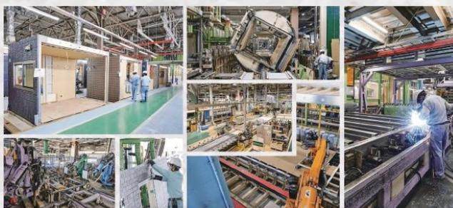
積水公司在踏入生產整體衛浴轉型後，又投入了預鑄建設工法。這種技術不僅是單純的RC結構預鑄，而是在工廠內完成窗戶、隔音牆、門框等設備的安裝，並能在工地現場直接進行吊裝。這種先進的工法在地震帶的台灣曾受到質疑與挑戰，我們此次參訪將深入了解這項技術在日本的應用與成效。
