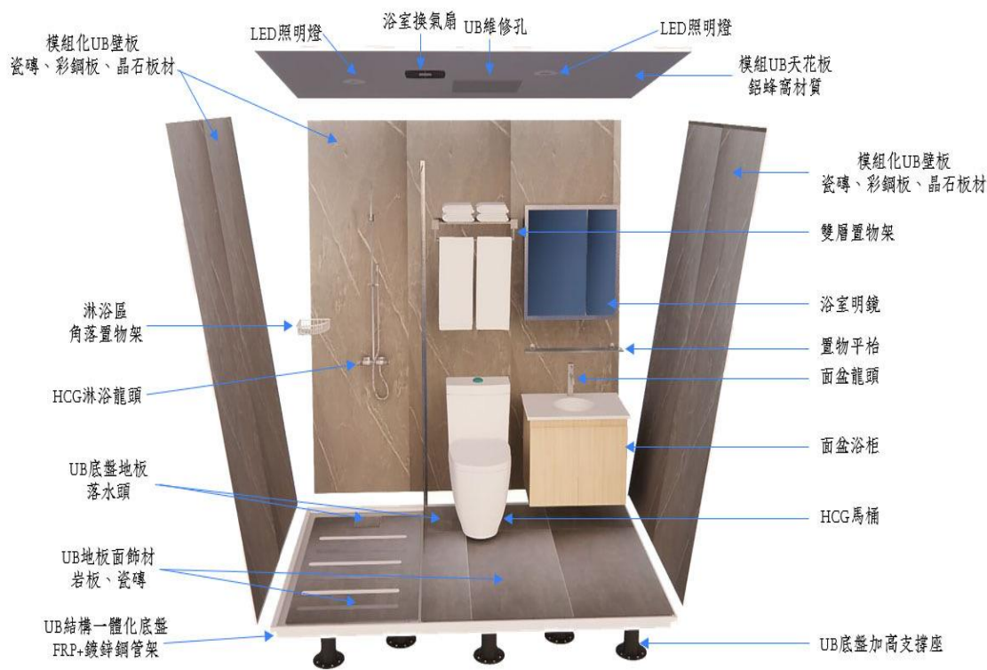
圖 3 HCG 和成整體衛浴設備展開圖
